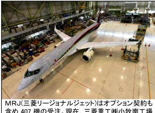
MRJ(三菱リージョナルジェット)はオプション契約も含め 407 機の受注。現在、三菱重工㈱小牧南工場で試験機の製造が進められており来月 18 日に飛行試験初号機がロールアウト、来春には初飛行の予定。今回の 9 月補正(一般会計)にMRJ見学者等の受入体制の在り方検討で 500 万円の予算計上。
